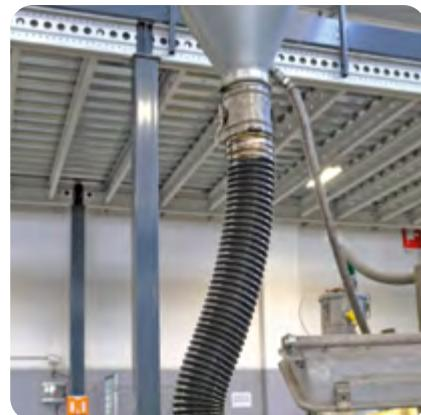
**Aplicaciones y normativas:** Manguera multiuso para la aspiración y la conducción de aire, humo, polvo, serrín, astillas y para el paso de cables eléctricos. También está indicada para el desagüe de condensados en el sector de la climatización y para la protección de conductos de cobre en las instalaciones de gas.
