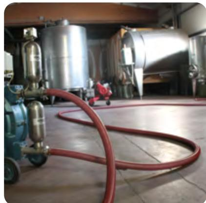
**Aplicaciones:** Manguera para la aspiración e impulsión de líquidos alimentarios sin contenido de grasas y bebidas con un contenido alcohólico de hasta 50 grados. Se utiliza para aplicaciones medio-duras en la industria enológica.
