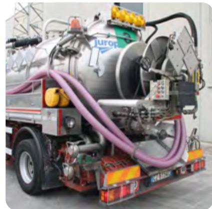
**Aplicaciones:** Manguera para la aspiración e impulsión en camiones cisterna para riego, desagües y limpieza de alcantarillados y pozos ciegos y para todas las aplicaciones medio-pesadas de la industria en general.
