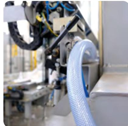
**Aplicaciones:** Manguera para la conducción de líquidos alimentarios, aire, soluciones químicas... Idónea para aquellos trabajos en los que se necesita alta resistencia a la presión.
